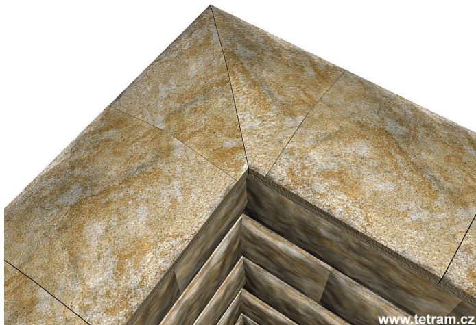
roh je tvořen dvěma hlavicemi seříznutými pod úhlem 45 stupňů (model)
