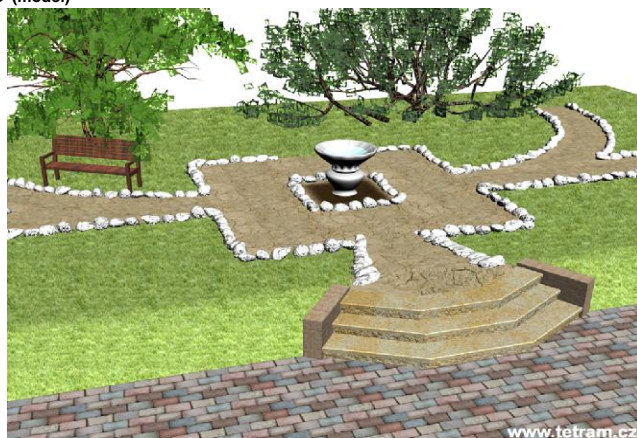
Schody je možné kromě klasické rovné varianty sestavit i do širokého schodiště seříznutím a sesazením stupnic a podstupnic (viz ukázky nahoře a dole). Schody mají na obou vyobrazeních tesané podstupnice. (model)
